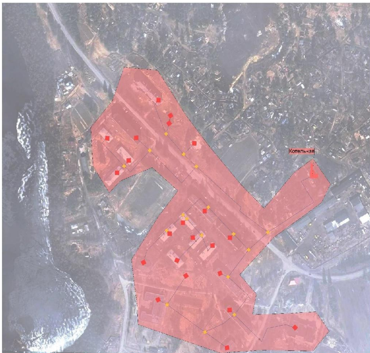
Рис. 2.1 - Зона действия источника тепловой сети
