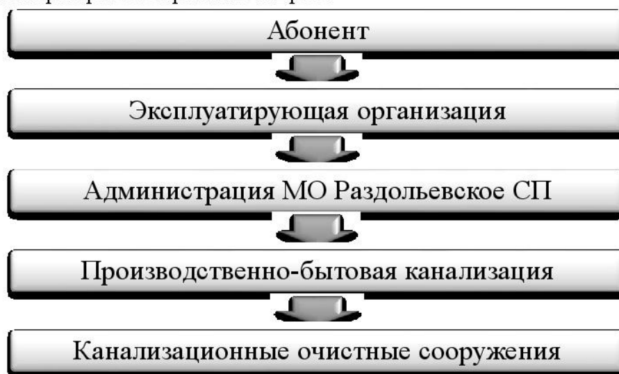
Рисунок 2.4 – Функциональная схема водоотведения
