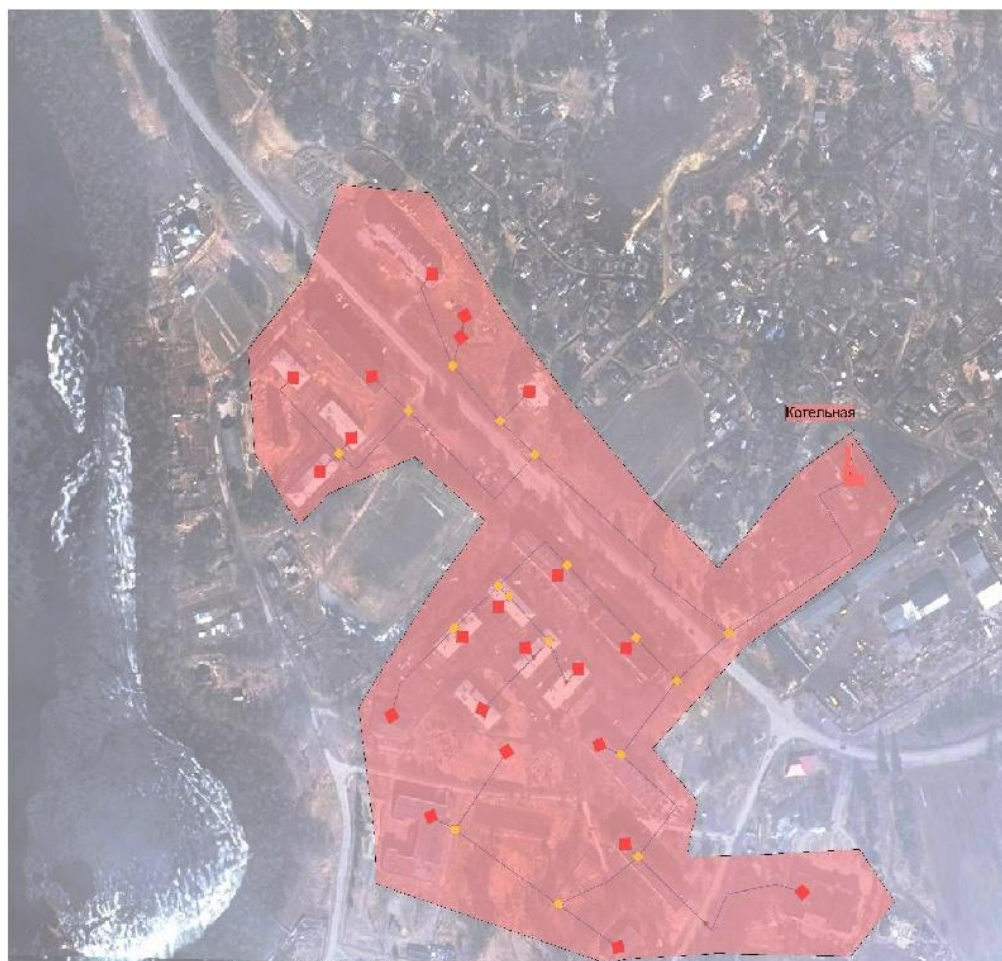
Рисунок 6.2 - Существующая зона действия источника тепловой энергии.
